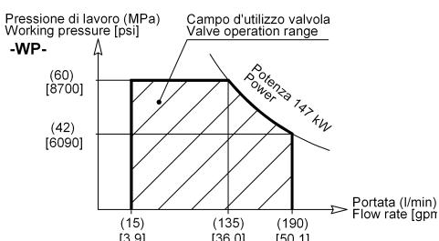
**VORSICHT:** Für eine korrekte Arbeitsweise des Ventils verwenden Sie Minimaldurchflüsse, die unterhalb der unten angegebenen Werte liegen.
